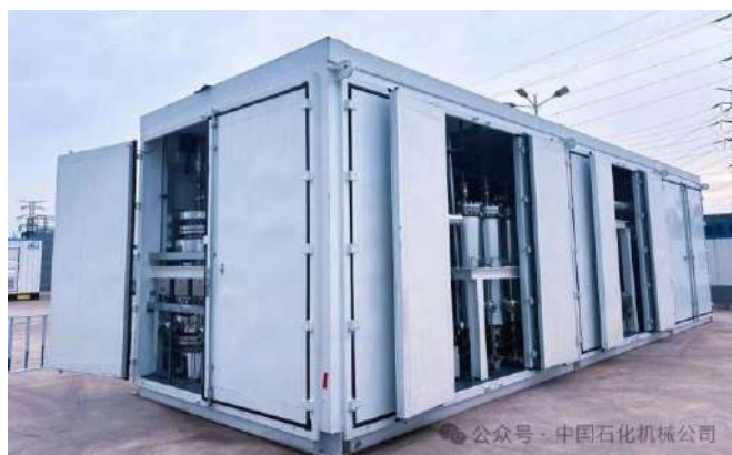
石化機械製のコンテナ型 PEM 水電解設備用 BOP
