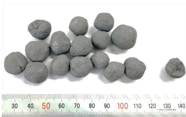
図.今回グリーン水素により試作した還元鉄（左）と直接還元試験設備（右）（JFE スチール東日本製鉄所）
